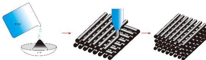
图 2 POXC/CPC 支架成型示意图
